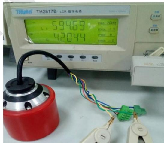
如上图有图所示则相电感 $L_s=594/2=297\mu\text{H}=0.297\text{mH}$
